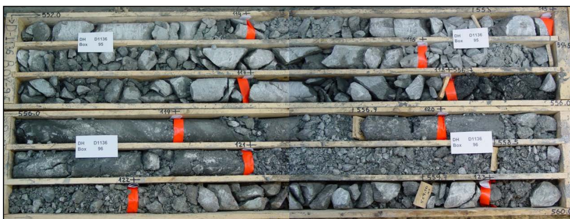
Рисунок 4 – Альпийские тектониты, представленные несцементированным дроблённым материалом и полосчатыми рыхлыми тектоническими брекчиями по пирит-карбонатным метасоматитам в рудной зоне. Месторождение Кумтор, Центральный участок, скважина D1136 – фото керна; 1/5 нат. величины
