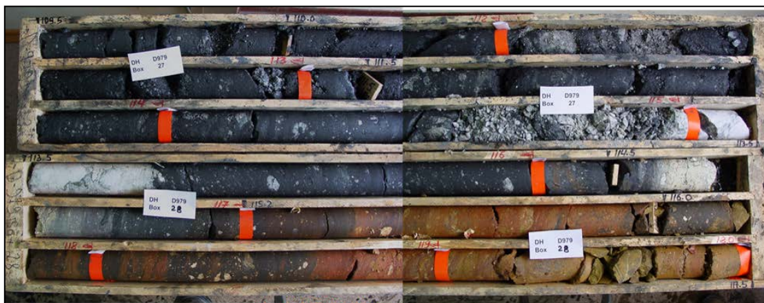
Рисунок 3 – Альпийские тектониты, представленные несцементированным дроблённым материалом и полосчатыми рыхлыми тектоническими брекчиями в основании Альпийского тектонического меланжа. Месторождение Кумтор, Центральный участок, скважина D979 – фото керна; 1/5 нат. величины
