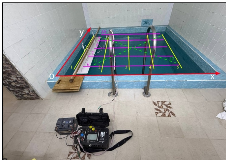
Рисунок 1 – Бассейн, именуемый далее «бак», с изображением профилей для оценки влияния боковых стенок. Использовалась линейная(стандартная) установка. Всего профилей 10, из них 1-5 профили направлены по оси x, профили 6-10 по оси y. Показана аппаратура Скала-48. Прерывистой прямой линией показаны диагональные профили
