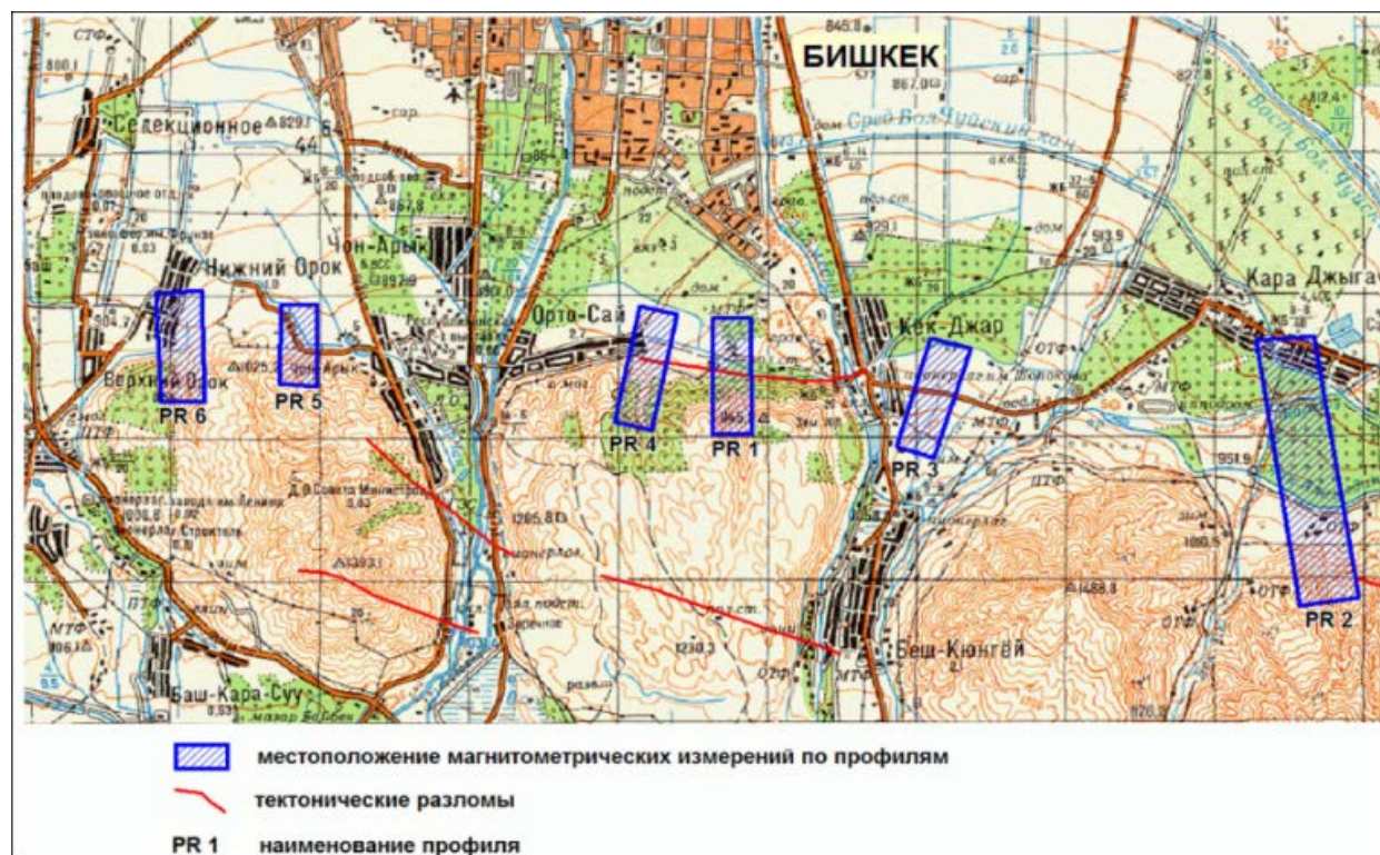
Рисунок 4 – Инженерно-геономическая карта на топографической основе инструментального определения ширины Иссyk-Атинского разлома для прогноза возможного проявления георисков от разломной раздробленности Бишкекского геодинамического полигона. Масштаб 1:200000 (ЦАИИЗ, 2021 г.)
